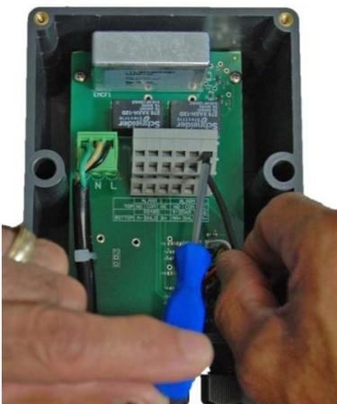
Abbildung 6: Elektrische Anschlüsse am Klemmenblock (P1)
