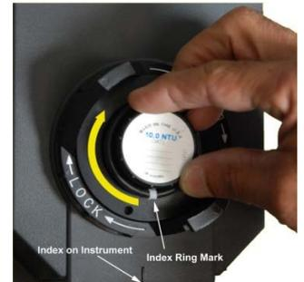
Wenn Sie die Standards in Zukunft verwenden, setzen Sie den Standard immer so ein, dass der Zeiger des Indexierungsrings nach vorne zeigt. Drehen Sie den Standard langsam etwa 5° vor und zurück, um den tiefsten Punkt zu finden. Der Standard ist nun indiziert und einsatzbereit.
