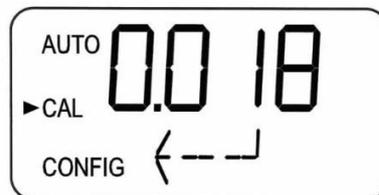
13. Setzen Sie den gewünschten 0,02 NTU-Standard ein. Indexieren Sie den Standard auf den niedrigsten Wert in der oberen Anzeige.
